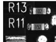
可使基板上的字符、芯片零件的字符以及镀焊层成像。
