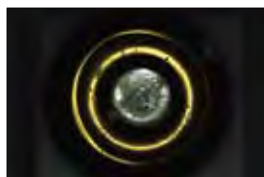
难以均匀地照射焊锡部分全体。
