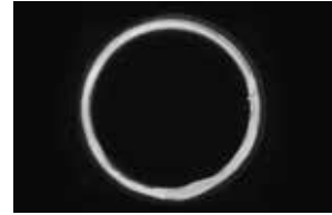
由于只有胶产生荧光散射, 因此可实现涂抹状态的成像。
