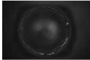
使用可见光光源难以检测胶的涂抹状态。
