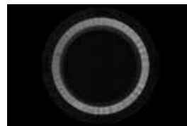
难以均匀地照射外围的倾斜部分。
