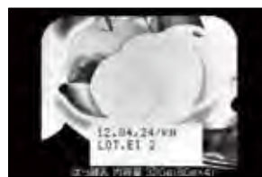
通过均匀地照射表面，可使印字清晰地成像。
