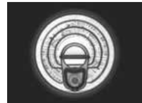
在LWD295mm 的照射下可实现强调表面凹凸的成像。
