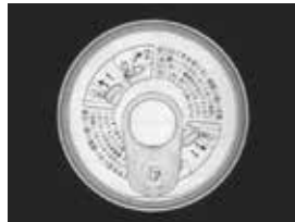
在LWD10mm 的照射下可均匀地照亮全体, 实现没有凹凸的成像。
