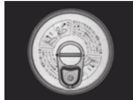
在LWD85mm 的照射下可实现仅强调拉环部分凹凸的成像。
